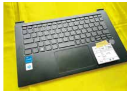
■ 実際にカバーを締めるときにベンが挟まりヒ ンジが破損した例。当日修理をさせたい だいたキーボード側外装交換を実施しました。
